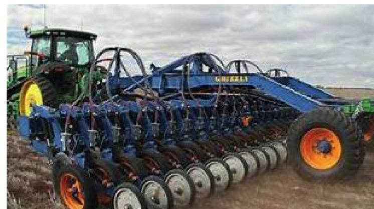
Suspensión de sembradora neumática diseñada con ROSTA DR ®
