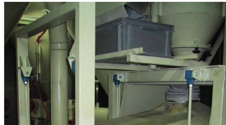
Cernedor diseñado con suspensiones ROSTA AV ®
